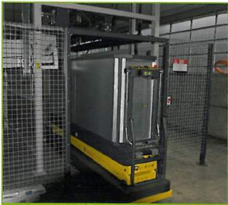
De oogstwagens rijden via de inductiekabel naar de overslagunit.
