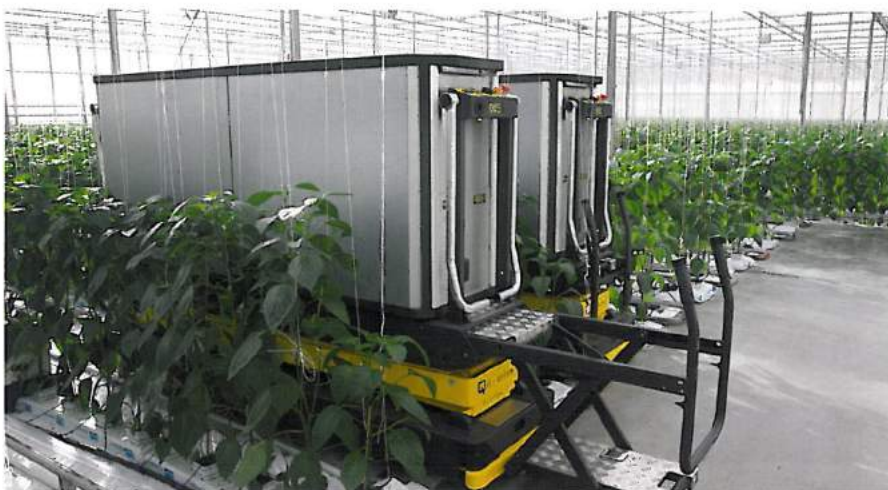
De oogstwagens hebben een in hoogte verstelbaar platform dat comfort biedt bij het plukken.
