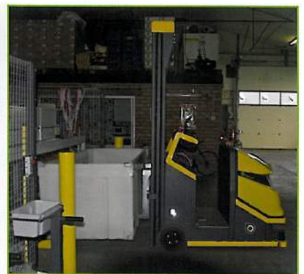
De automatisch geleide heftruck zet een volle container in de buffer.
