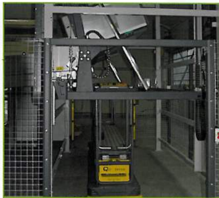
Een gripper pakt de containers van de kar, licht ze op en draait ze voorzichtig om.
